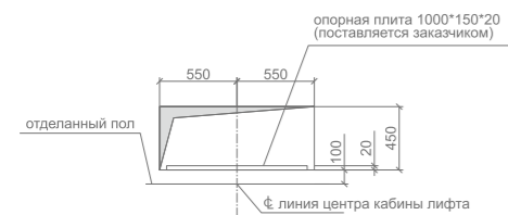
А-А грузоподъёмность проёма
