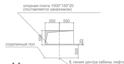
А-А грузоподъёмность проёма
